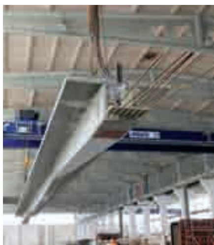
Abb. 4 Demonstrator eines Halbfertigteils nach dem Vorspannen und Ausheben aus der Schalung im Werk von Hentschke Bau
