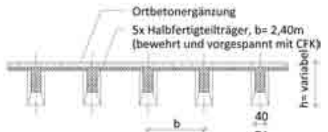
Abb. 3 Querschnitt in Feldmitte eines Fertigteils mit Ortbetonplatte
