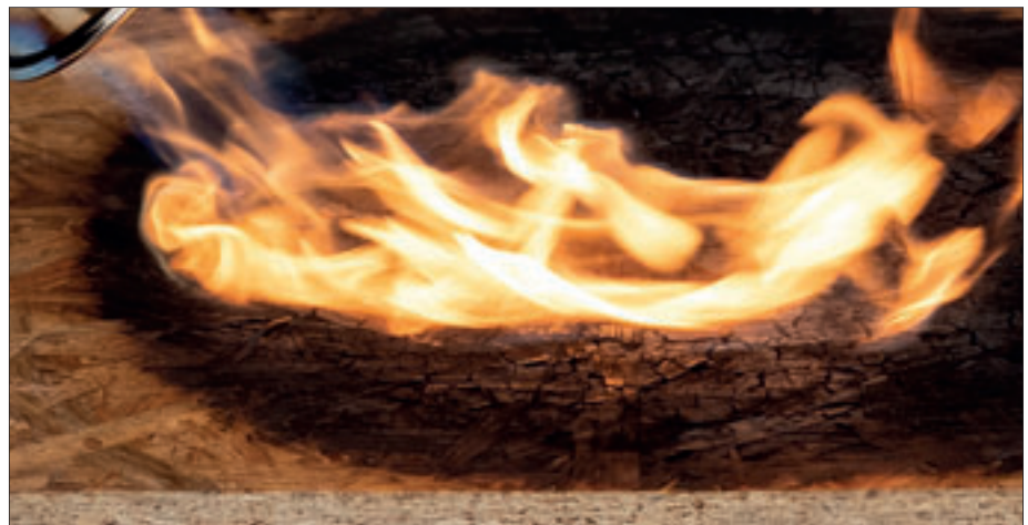
SWISS KRONO OSB/3 SF-B bildet durch Verkohlung eine feuerhemmende Schicht.
