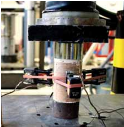
Abb. 2: Druckprüfung eines Lehmzylinders mit Messung der Längsdehnung durch drei Clip- On Extensometer
