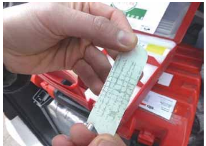
Abbildung 9: Ansicht des abgerissenen Klebebandes der Gitterschnittprüfung
