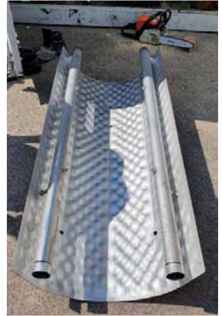
Bild 4: Abwasserwärmeübertrager der Fa. Uhrig Kanalbau, unmittelbau vor Einbau Bild Ingenieurbüro Lang
