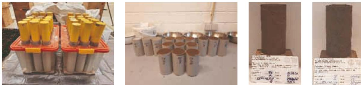
Abbildung 2: Versuchsstand der Kleinversuche und ausgeschaltete Probekörper
