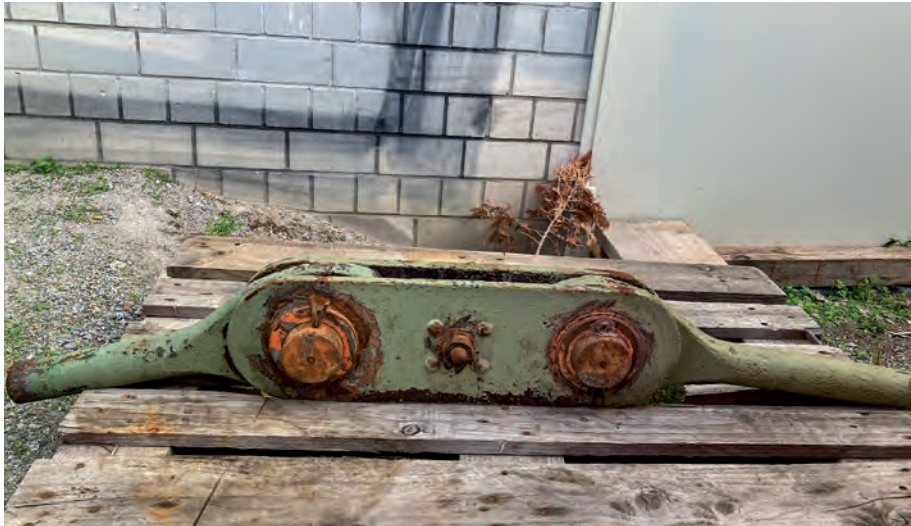
Altes Zugband aus dem Ostbahnhof bzw. der gelenkige Verbinder, der dafür sorgt, dass keine Spannung in das System kommt.
