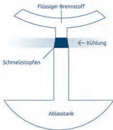
Abb. 4: Skizze der Schmelzsicherung: Bei übermäßiger Erwärmung löst sich der gefrorene Pfropfen auf und der Brennstoff fließt in sichere Auffangbehälter.
