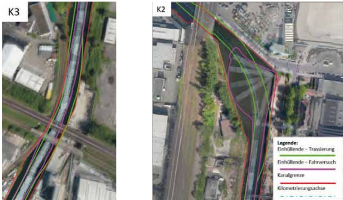
Abbildung 2: Ergebnisse der Trassierung im Vergleich zu den Fahrversuchen des Schiffs Mark Brandenburg.
