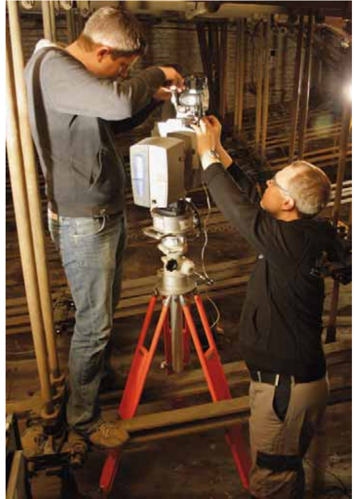
Bild 9: Bauaufnahme mit Laserscanner, hier in der Decke über dem Thronsaal (Heres 2009)
