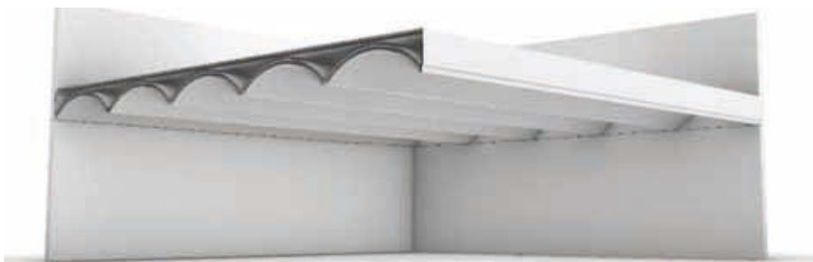
*Abbildung 1: Skizze eines Deckensystems mit Tonnenschalen*
