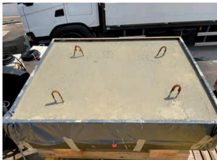
Abbildung 4: Modell kurz nach der Betonage
