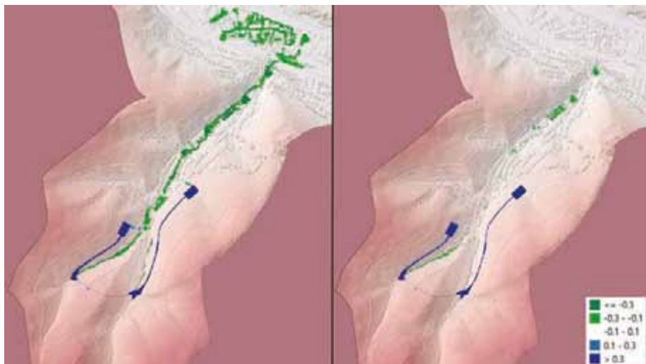
Abbildung 5: Differenz der maximalen (links) und der durchschnittlichen Wassertiefe (rechts) in [m] (mit QGIS erstellt)
