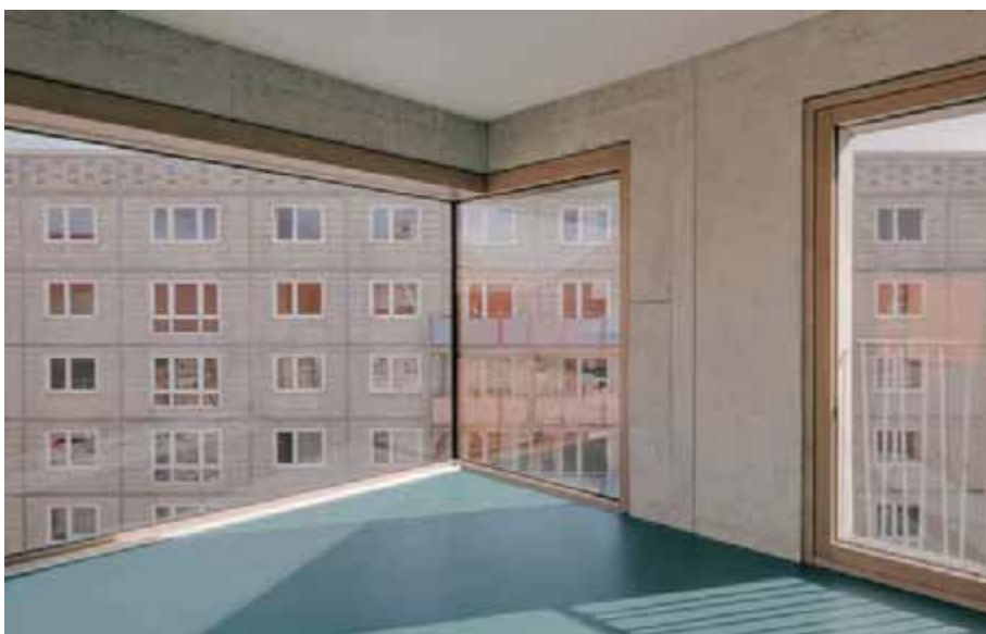
Bild 2: Unbekleideten Leichtbetonaußenwände harmonieren mit Fensterprofilen aus Red-Grandis-Holz, weißen Decken und Böden aus einer blauen Kunststoffbeschichtung.
