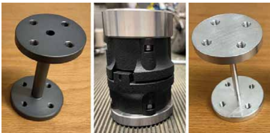
Abbildung 2: Verbindungsbauteile (v.r.n.l.): Standardbauteil VBT 1 (steif), Sonderanfertigung VBT 2 („weich“), konstruiertes neues Verbindungsbauteil VBT 3 (weich)
